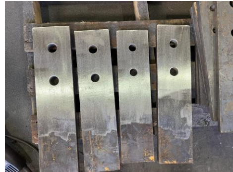
写真4 ローラサンダー施工後
