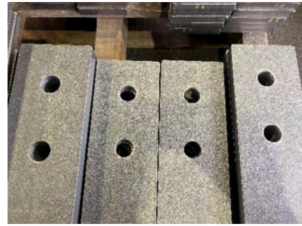
写真3 ショットブラスト施工後
