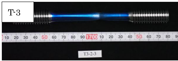
図 8 溶接金属引張試験後の試験片
