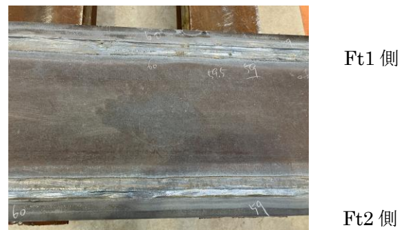
図4 試験体 No.3 TSAW 溶接外観
