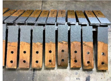
写真5 ショットブラスト施工後のさび発生状態
