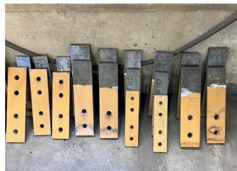
写真6 ローラサンダー施工後のさび発生状態
